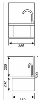
Lave main hygiène fabrication en inox, muni d'un premelangeur ec/ef, col de cygne, siphon, flexible de liaison, robinet poussoir avec clapet antiretour, dossier arrière, mise en route par pression du panneau avant avec le genou. Fixation murale par le haut du dossier. Cuve emoutie de forme tronconique à fond plat, haut.305, bas 190, profondeur 160.
