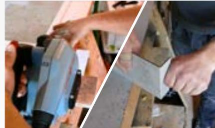
**Angle sans profilé :** il est possible de réaliser une rainure à l'arrière des panneaux grâce à une fraiseuse à rainure en V. Les panneaux peuvent ainsi être pliés pour une pose sans profilé.
