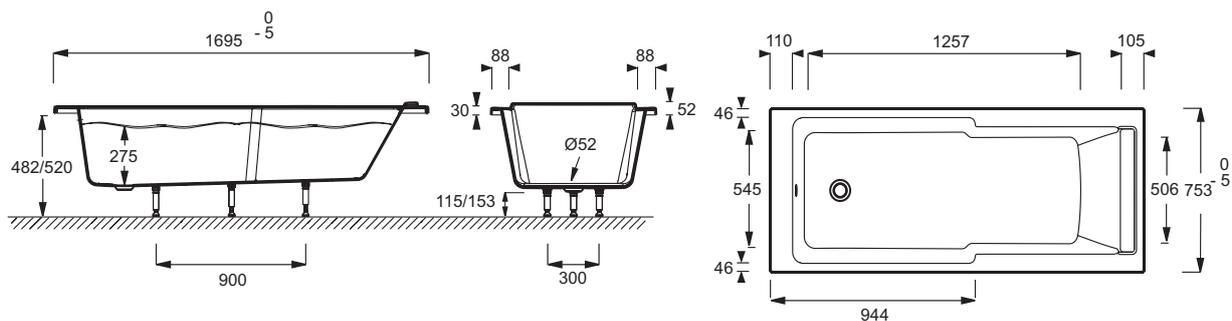
Description : Baignoire bain-douche 170 x 75 cm. E6D021. Collection : STRUKTURA. Dimensions : 170 x 75 cm. Poids : 25,5 kg. Matériau : Acrylique. Installation : Encastré. Volume : 192/122. Forme : Rectangulaire. Hauteur des pieds : 115/153. Diamètre de bonde : 5,2 cm. OPTIONS : Pare-bain pivotant, vidage avec bonde à recouvrement. DIMENSIONS FOND DE CUVE : 115,7 x 47 cm.
