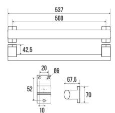
Tube elliptique  $38 \times 25 \text{ mm}$  en aluminium époxy blanc. Cache-fixations en résine de synthèse chromé mat.
